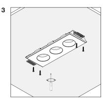
Установите корпус (поз. 1) в отверстие и закрепите его с внешней стороны потолка саморезами, идущими в комплекте (поз. 4).
