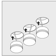
Установите световые модули (поз. 2) в корпус светильника на магнитную планку.
