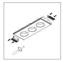
Отрегулируйте крепежный элемент (поз. 3) в зависимости от толщины потолка.
