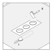
После установки следует зашпатлевать швы, покрасить потолок и гипсовый корпус светильника.
