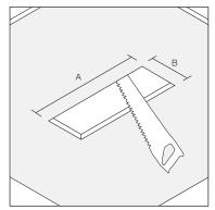
Сделайте отверстие в гипсокартонном потолке, соответствующее выбранной модели (размер АхВ) (см. таблицу).
