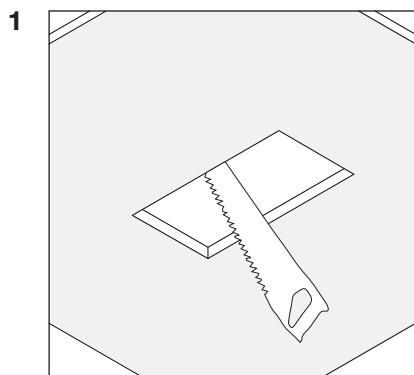
Сделайте отверстие в гипсокартонном потолке, соответствующее выбранной модели (см. паспорт выбранного светильника).
